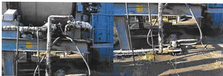
Pompa de inalta presiune si filtre improvizate
